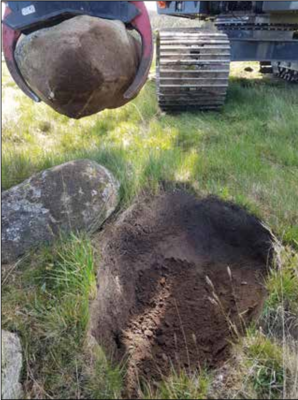
Figur 4. Vissa stenar lyftes med gripklo för att kontrollera hur djupt dessa låg. På bilden syns en sten som ligger djupt ned i matjorden, men inte ner i undergrunden utan med ett decimetertjockt skikt med matjord mellan stenen och undergrunden. Fotograf Ola Kadefors. Fotonummer 2020-37_6.
